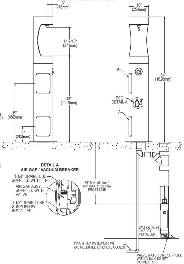
**DETAIL A AIR GAP / VACUUM BREAKER**
